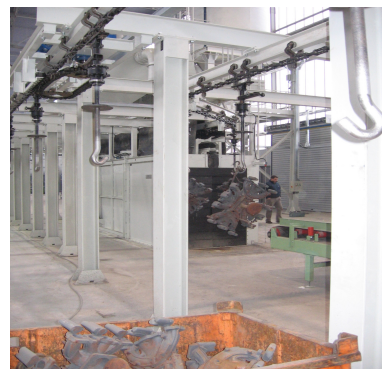
Stroj tipa A. Dve poziciji za peskanje. Machine type A. Two blasting positions.
